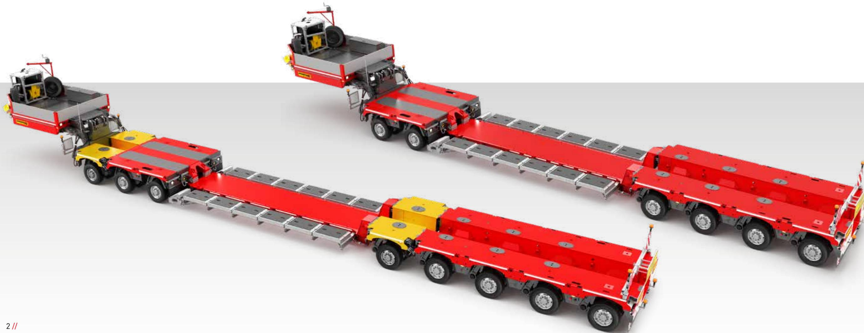
Die Stärken des VarioMAX Plus Tiefbett-Aufliegers liegen in seinen hohen Nutzlastmöglichkeiten, der modularen Vielseitigkeit und der wendigen Fahrweise. Der VarioMAX Plus ist die nutzlasteroptimierte Lösung zum Transport von schweren Baumaschinen im Bereich Tief-, Hoch- und Straßenbau, **mobile Brechanlagen** aus der Abbruch- und Recyclingbranche und **Transformatoren**.
