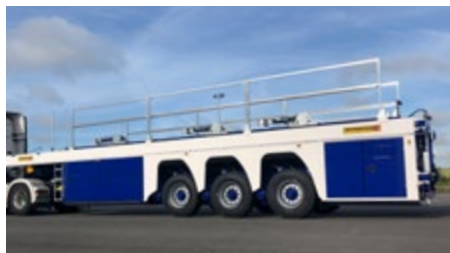
Zabezpieczenie przed upadkiem bocznym na belkach wzdłużnych
