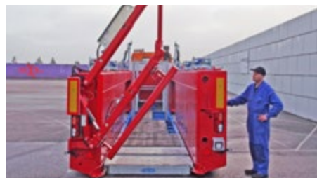
Wielofunkcyjne tylne drzwiczki hydrauliczne można obracać poziomo/pionowo i regulować ich szerokość (standard w modelu PrefaMAX-A).
