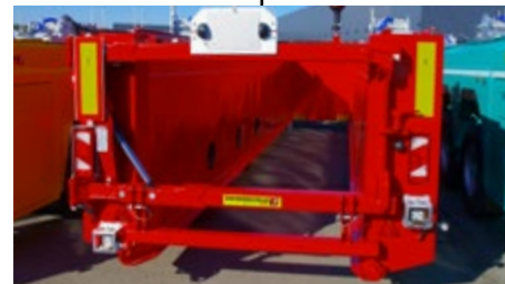
Puerta trasera ajustable verticalmente, con activación hidráulica
