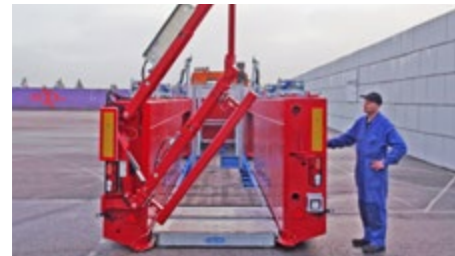
La puerta trasera multifuncional hidráulica puede pivotar en horizontal y en vertical, y su anchura es ajustable (de serie con PrefaMAX-A).
