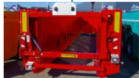
Vertikal aufstellbares Rückwandtor, hydraulisch betätigt
