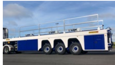
Seitlich steckbare Laufsicherung an den Längsträgern
