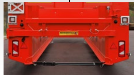
Querstange unten an der Schlussstraverse mit Exzenterverschluss
