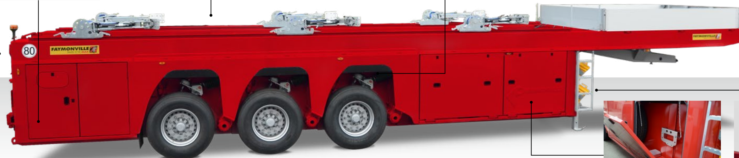
Serienmäßige Ausstattung: Vor dem Achsaggregat beidseitig abnehmbare Vollverkleidung *
