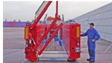
Hydraulisches Multifunktionstor, horizontal/vertikal schwenkbar und breitenverstellbar (serienmäßig bei PrefaMAX-A)
