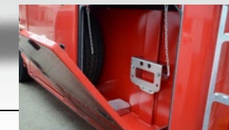
Serienmäßige Ausstattung: Vor dem Achsaggregat beidseitig abnehmbare Vollverkleidung *
